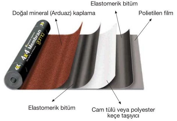
GAMA Arduazlı Membran Kesiti
