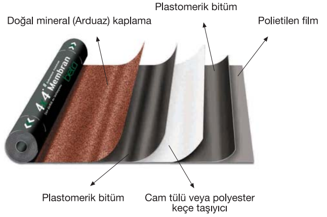
BETA Arduazlı Membran Kesiti
